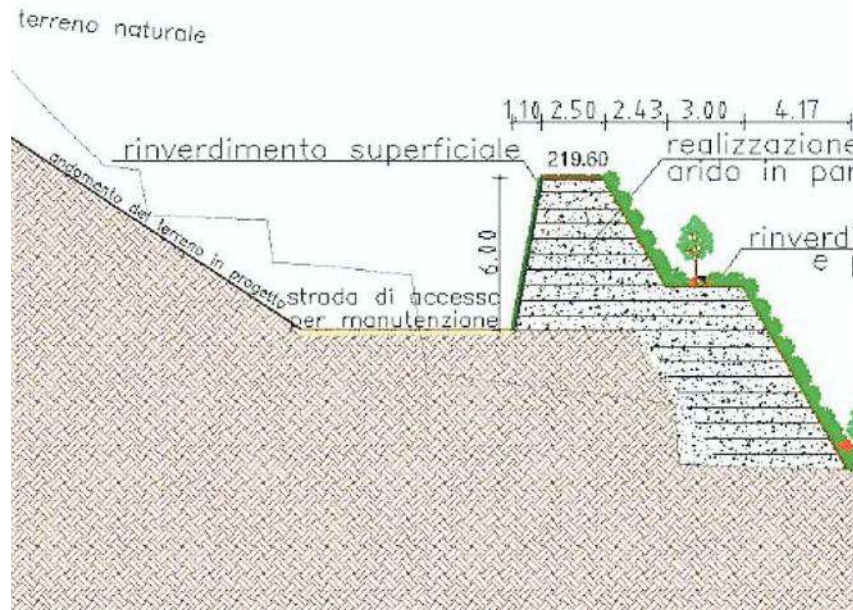
La soluzione adottata dalla Provincia: un vallo-tomo per difendere le case dalle frane
