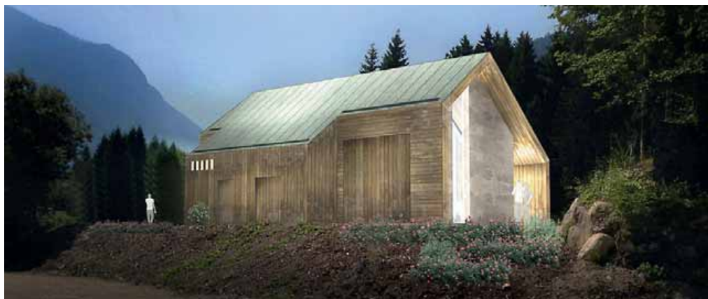
Il rendering della centralina sul Masolo che avrà un'opera di presa a quota 1.300 con restituzione dell'acqua a 1.080
