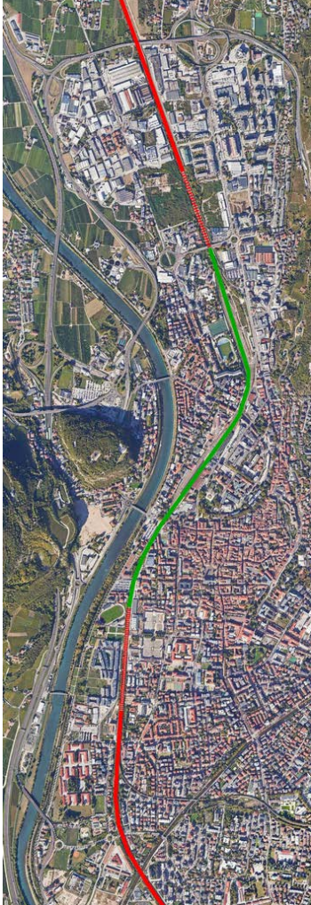
1. La ferrovia sarà interrata (linea verde) dallo stadio al ponte dei Caduti di Nassiriya.
